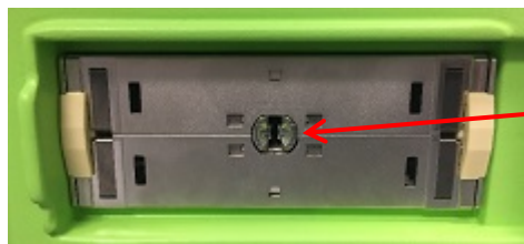
Εικόνα 7: Εγκοπή ασφάλισης στην υποδοχή συνδέσμου του ηχοβολέα
